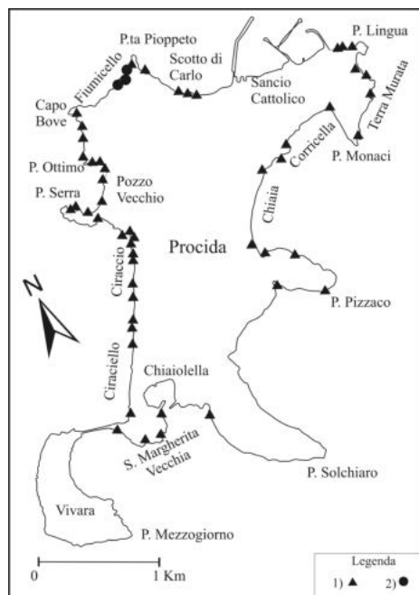
Fig. 70 - Frane costiere dell'isola di Procida (CALCATERRA et alii , 2003). 1) Crollo; 2) Scorrimento-colata.
