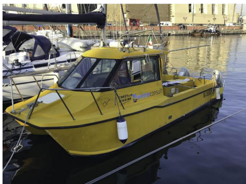
Fig. 7 - Motobarca catamarano “Enviroconsult” di Enviroconsult s.r.l. utilizzato per l’acquisizione dei rilievi side-scan sonar.
