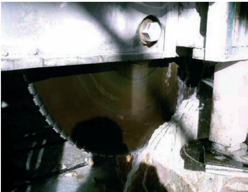
Macchinario per la segagione dei blocchi trasportati in segheria
